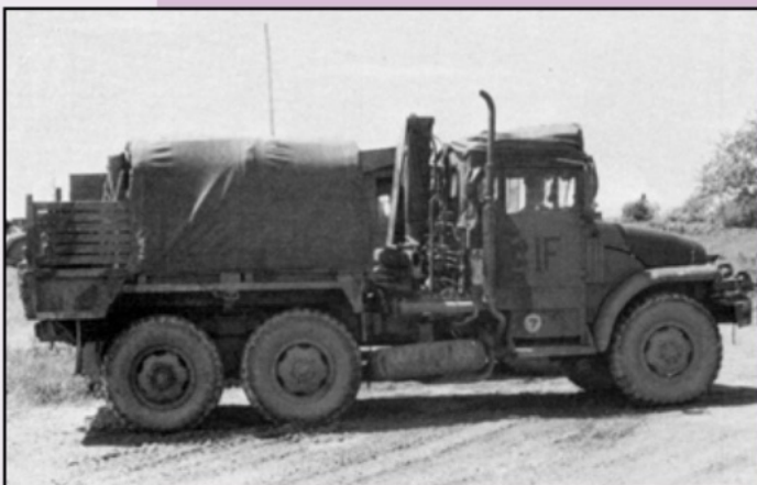
M135CDN en M211CDN met een ingekorte laadbak en een HIAB hydraulische kraan
