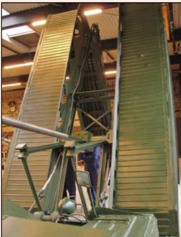
Het contragewicht aan de spindelkoker
