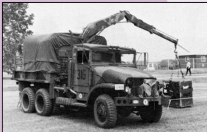
M135CDN en M211CDN met een ingekorte laadbak en een HIAB hydraulische kraan
